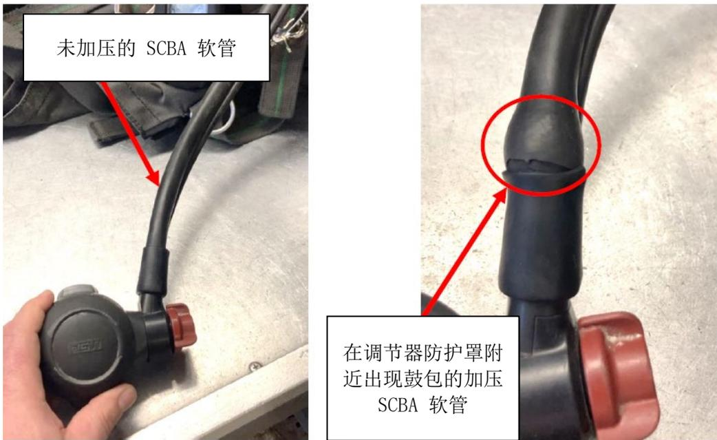
图 1 - 鼓包的调节器软管示例
